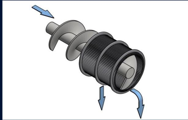
Unsere Siebschnecken-Siebzylinder haben viele verschiedene Anwendungsgebiete. Schneckenpressen sind die Lösung bei der Schlamm-, Gülle oder Gärreste-Entwässerung.
